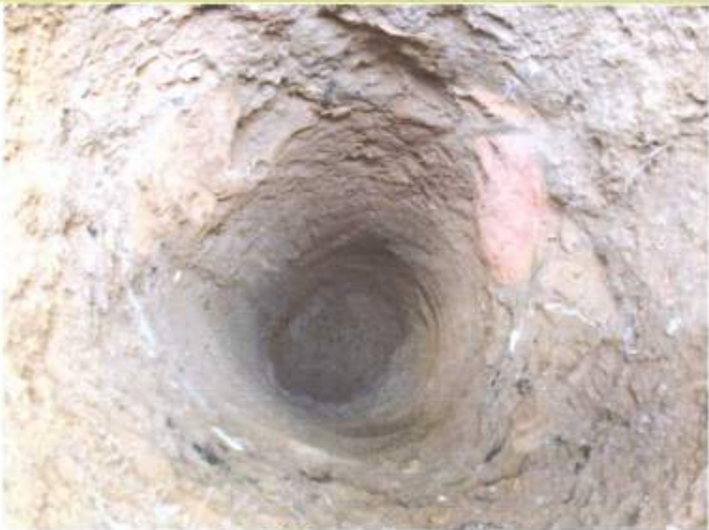
Foto 03: Furo realizado de SPT
